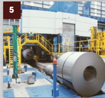
5 DÂY CHUYỀN CÁN NGUỘI COLD ROLLING MILL
